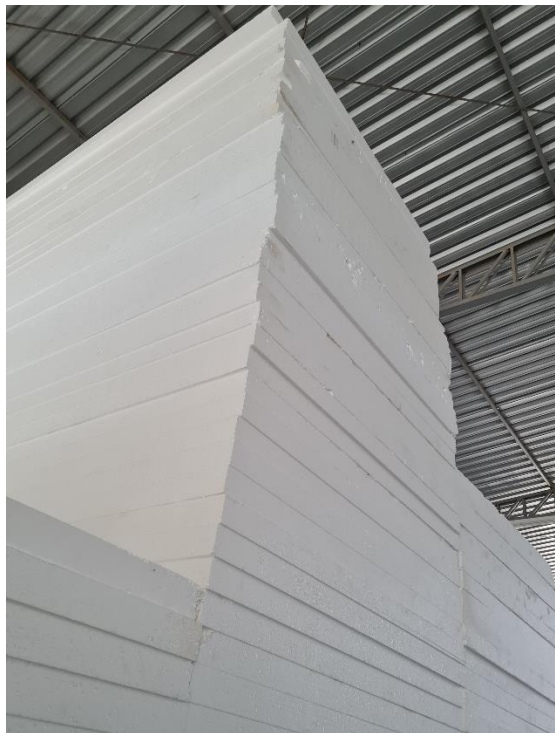
Figura 3.6 Painéis de EPS cortado
