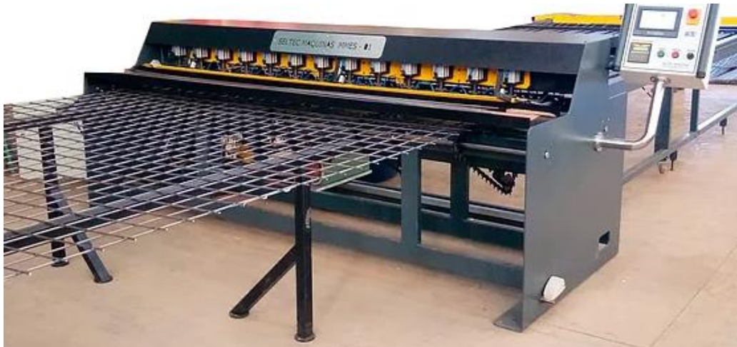
Figura 3.8 Máquina para Telas eletrosoldadas MMES 01
