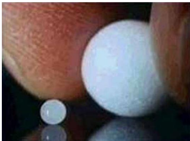
Figura 3.3 Pérola antes da expansão e granulado após a expansão
