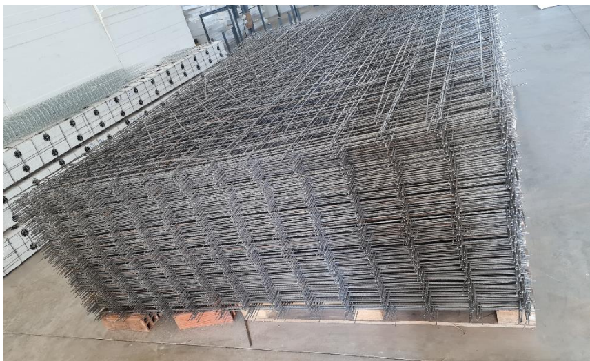
Figura 3.7 Tela soldada Q61 15X15 fio 3.4mm – 6x2,45 m (tela soldada utilizada nos painéis da EPS BRASIL)
