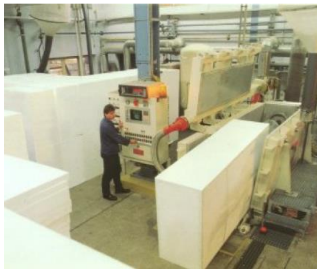
Figura 3.4 Processo moldagem de um bloco de EPS
