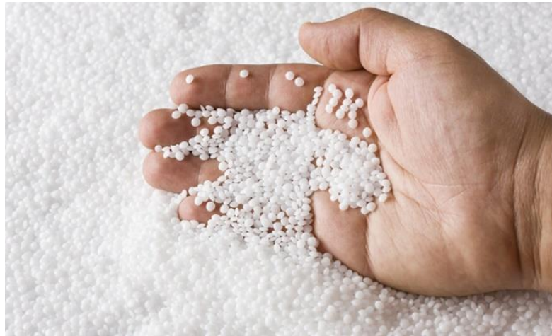
Figura 3.2 EPS de forma granular
