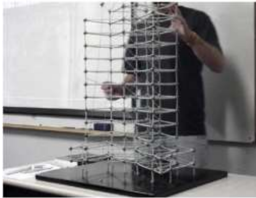
Figura 7 - Kit mola modelando uma estrutura
