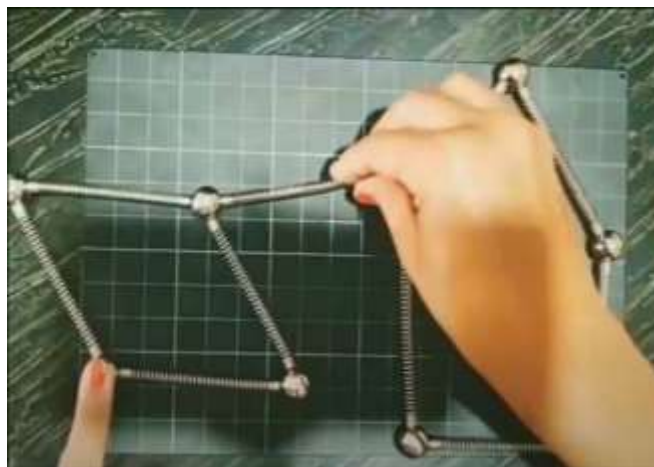
Figura 18 - Aplicação de uma carga horizontal no quadrado
