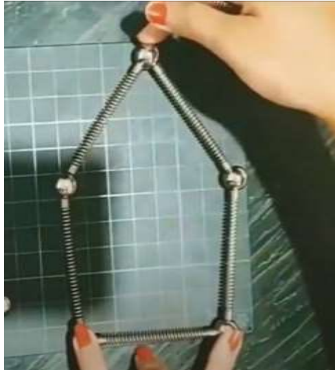
Figura 19 - Carga vertical sendo inicialmente aplicada no pentágono
