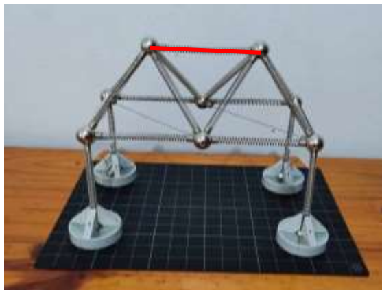
Figura 44 - Trelça montada com o Kit mola
