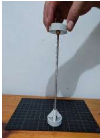
Figura 32 - Pilar com ligação rígida no apoio
