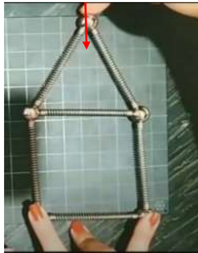
Figura 22 - Aplicação da carga vertical no nó do triângulo
