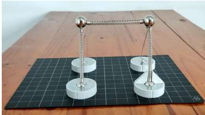
Figura 36 - Pórtico com uma ligação de apoio rígida
