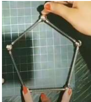
Figura 23 - Deformação da estrutura sem a barra horizontal
