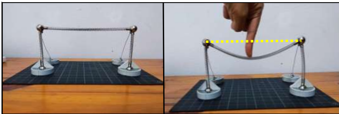
Figura 4 - Pórtico reproduzido com o Kit mola antes e depois da aplicação de uma carga pontual
