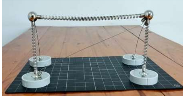
Figura 39 - Tirante adicionado à estrutura
