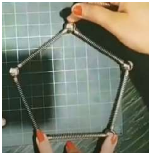
Figura 20 - Deformação do polígono devido a carga aplicada
