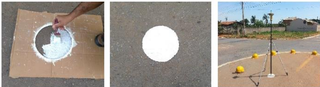
Figura 4 - Implantação de um alvo pré-sinalizado e rastreamento do mesmo.
