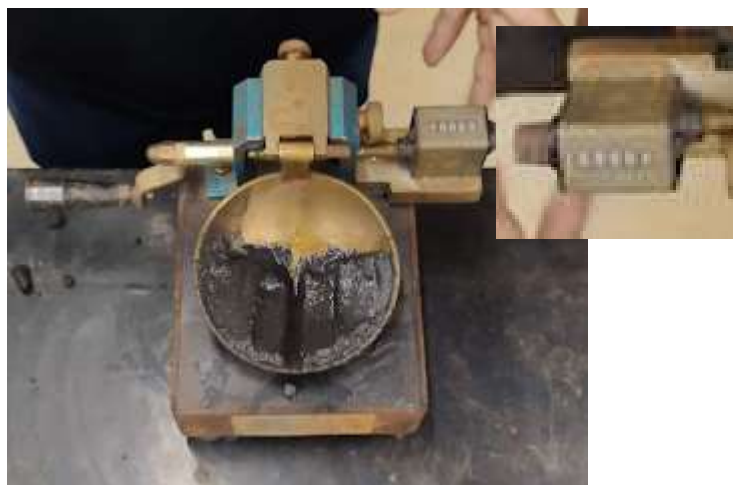
Figura 5.4 - Material após aplicação de golpes no aparelho de Casagrande
