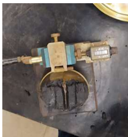
(b) Material após divisão com cinzel
