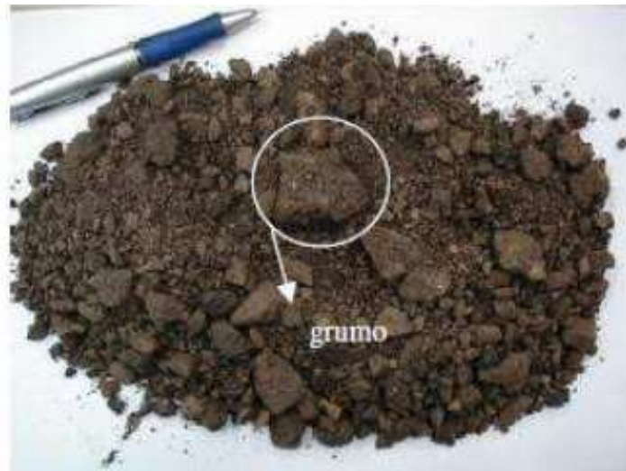
Figura 3.4 – Aspecto do material fresado de revestimento asfáltico
