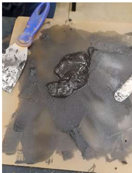
Figura 5.5 - Material na placa de vidro para determinação de Limite de Plasticidade
