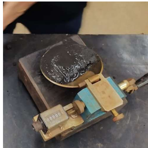
(b) Material durante transferência para aparelho de Casagrande.
