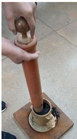
(a) Soquete caindo perpendicular ao cilindro
