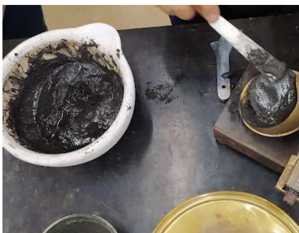
(a) – Colocação do material no aparelho de Casagrande
