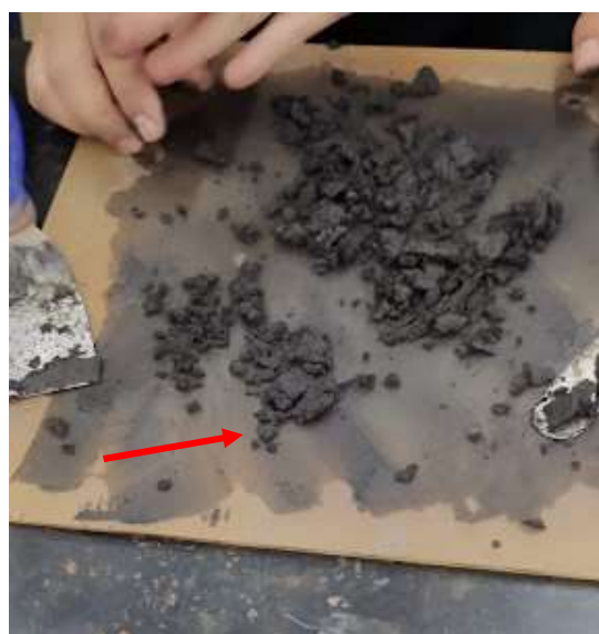
(b) Material após ser rolado sobre a placa
