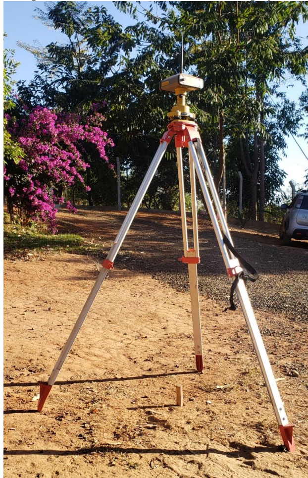
Figura 3 – Receptor GNSS utilizado durante a ocupação do ponto base.
