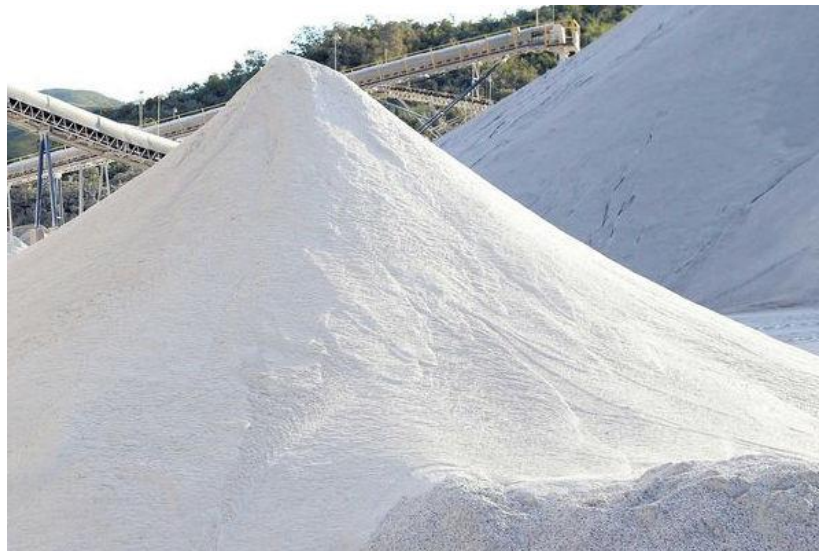
Figura 14 - Estoque de finos em pedreira por processo a seco.
