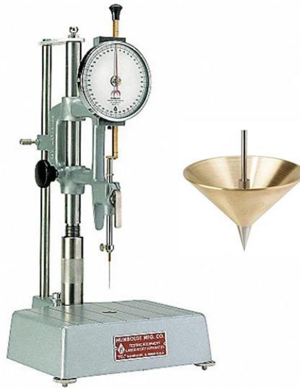
Figura 15 - Exemplo de equipamento manual de medida da penetração.
