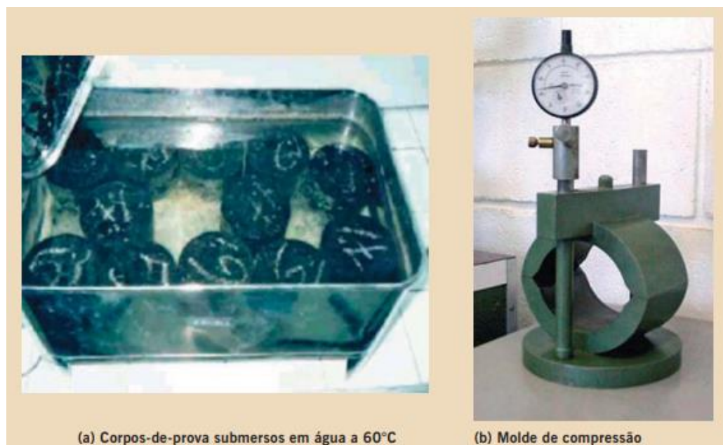
Figura 9 - Exemplo de corpos-de-prova submersos em banho-maria e molde de compressão.
