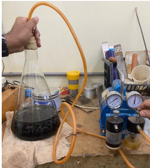
Figura 26 – Execução do ensaio “rice test”.
