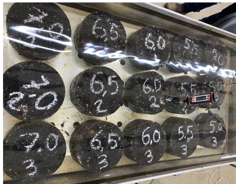
Figura 37 – Corpos de prova da mistura asfáltica com 30% de agregado reciclado submersos.
