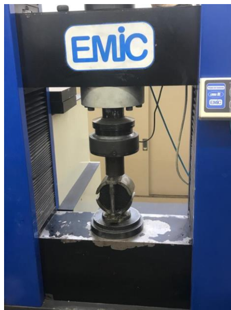
Figura 32 – prensa mecânica utilizada no rompimento dos CP's.
