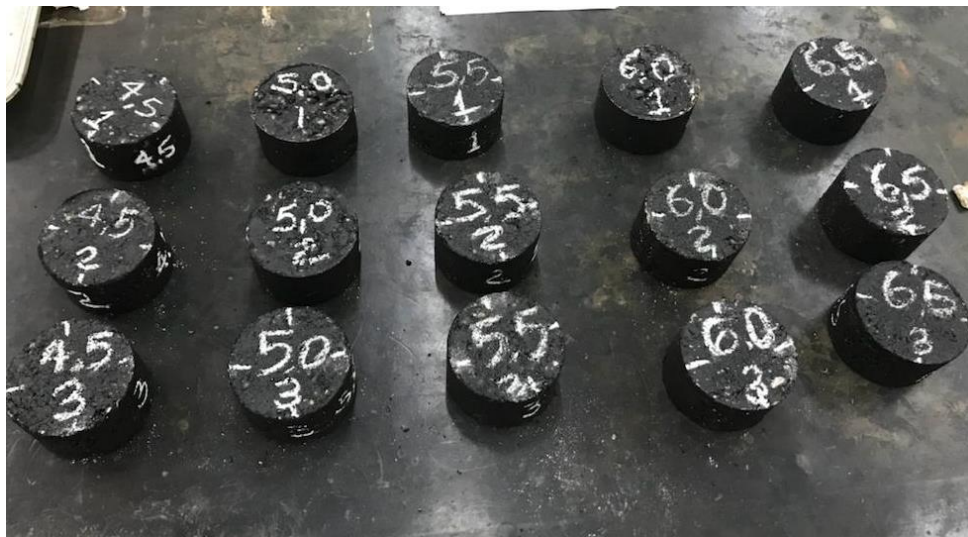
Figura 24 – corpos de prova moldados com 100% de agregado natural britado.
