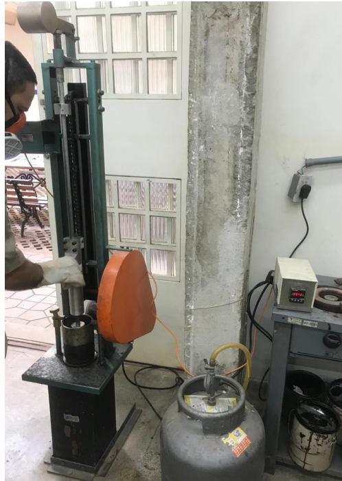
Figura 23 – Prensa utilizada para execução da compactação dos CP's do ensaio Marshall.
