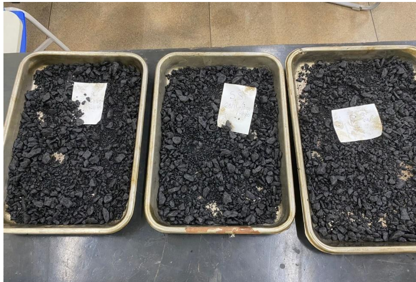
Figura 25 – Amostras preparadas para a execução do “rice test”.
