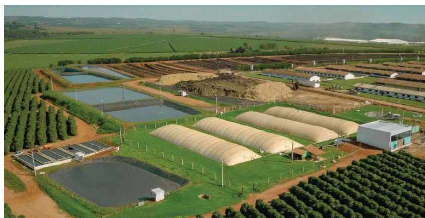
Figura 12 – Série de biodigestores tipo lagoa coberta para tratamento de efluentes suínos, 500 KWel.
