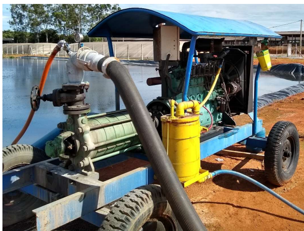
Figura 24 - Motobomba para aplicação do biofertilizante em uma granja de suínos em Campo Verde – MT.
