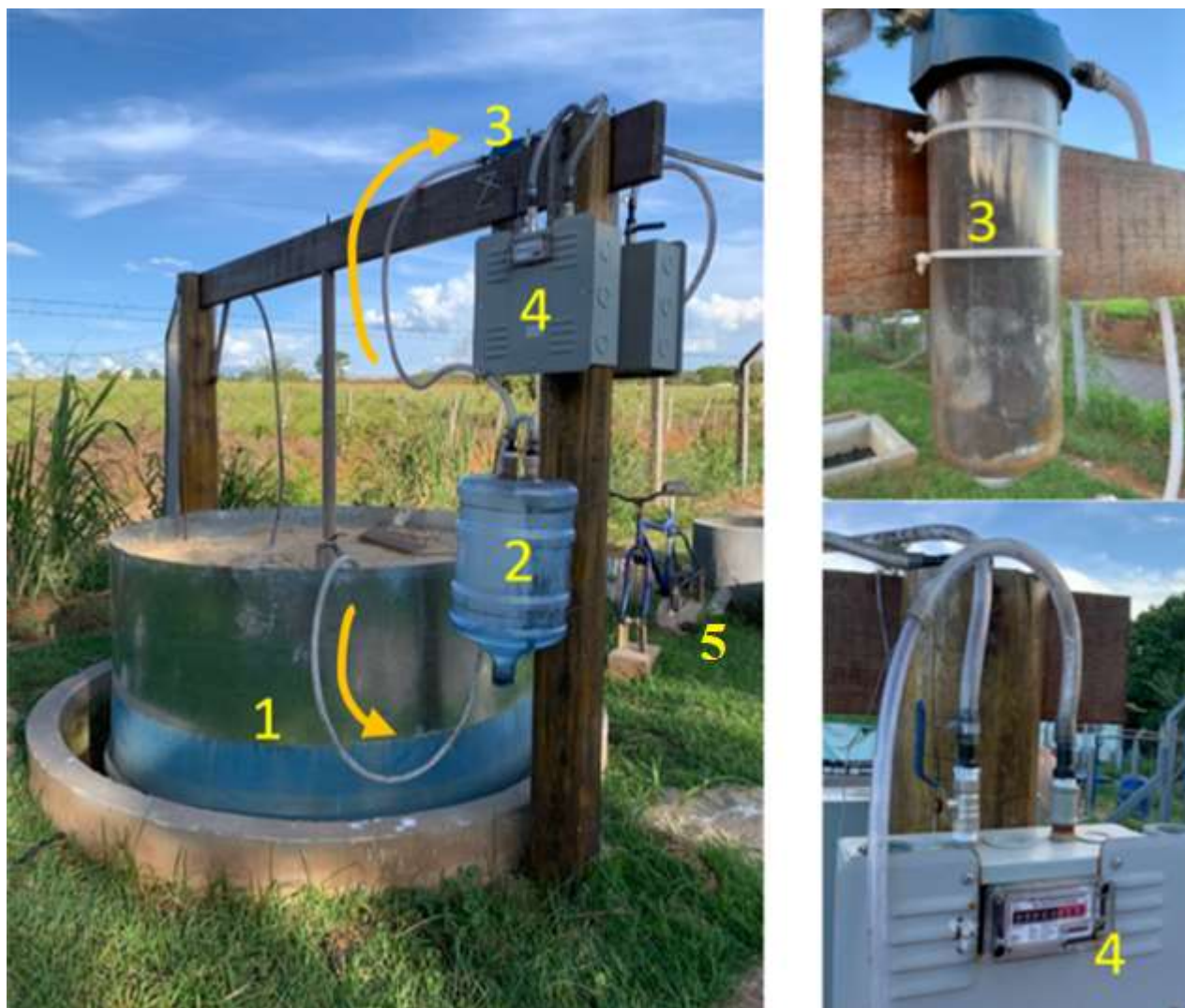
Figura 34 - Biodigestor Sertanejo implementado no BiogasLab IFG-UFG.
