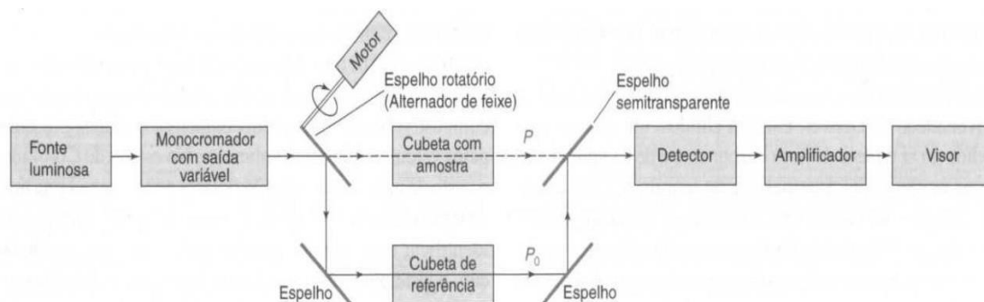
Figura 25 - Esquema do Espectrofotômetro de feixe duplo
