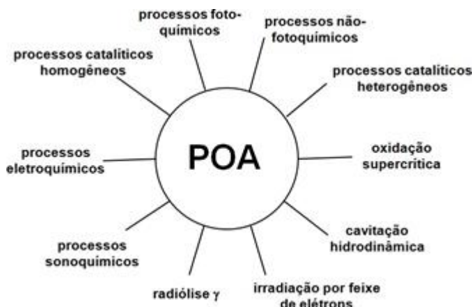
Figura 7 - Conjunto de métodos para processos oxidativos avançados
