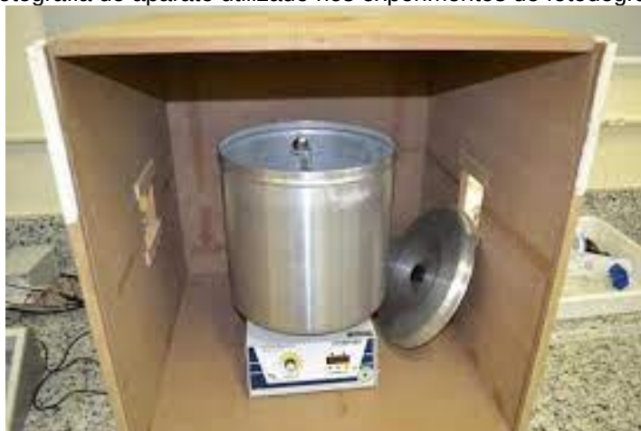
Figura 16 – Fotografia do aparato utilizado nos experimentos de fotodegradação com UV
