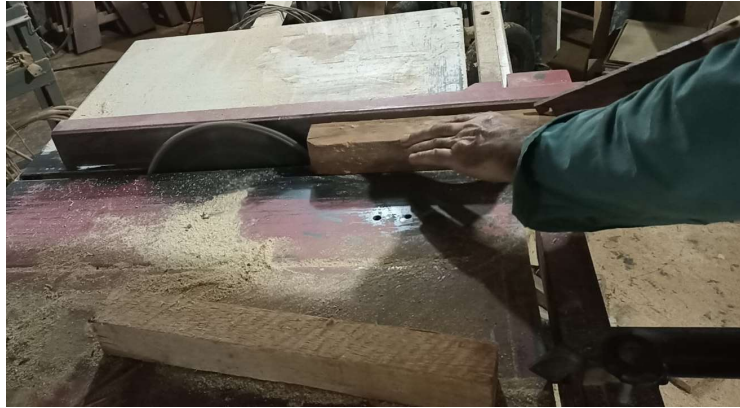
Figura 3.2 -Ilustração do corte dos corpos de prova em marcenaria
