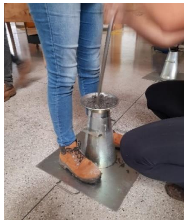
Figura 34: Preenchimento da terceira camada Figura 35: Adensamento da terceira camada
