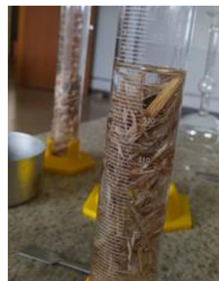
Figura 31: Materiais utilizados Figura 32: Proveta com álcool Figura 33: FBC imersa no álcool
