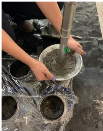
Figura 39: Adensamento com vibrador de agulha de imersão
