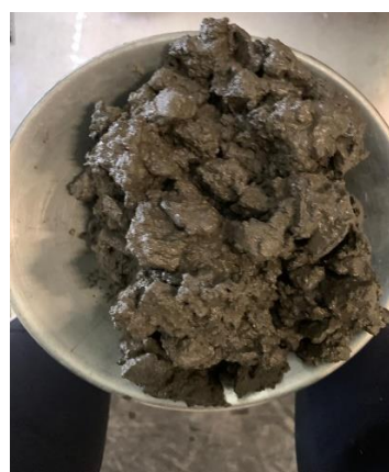
Figura 37: Concreto simultâneo 1% FBC+3,5%CBC
