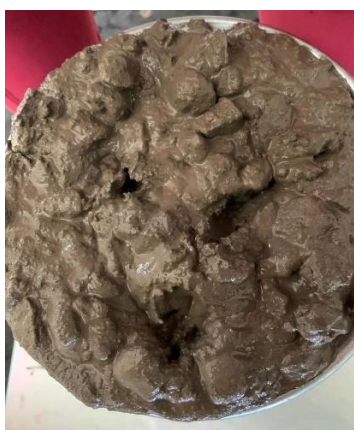
Figura 36: Concreto de Referência
