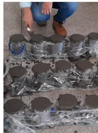
Figura 40: Rasamento das superfícies
