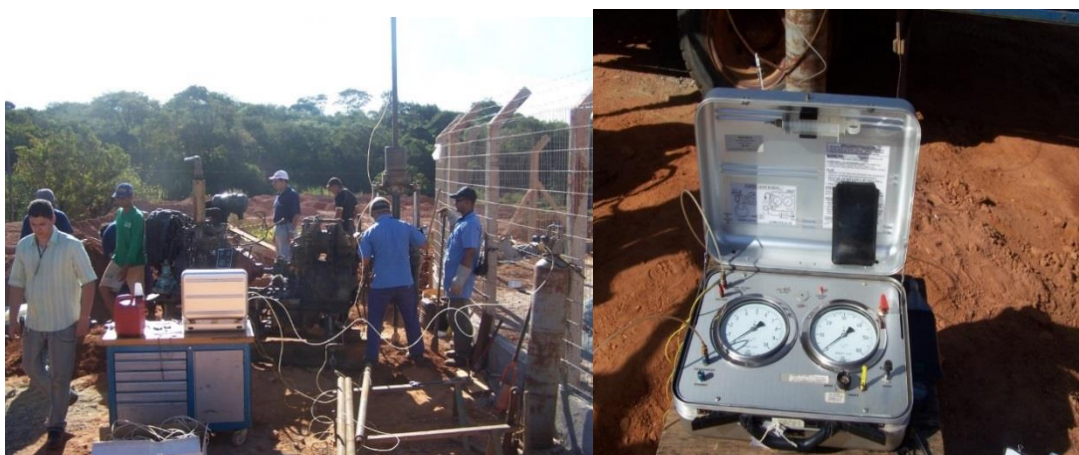
Figura 3.7 – Ensaio DMT e Caixa de controle DMT
