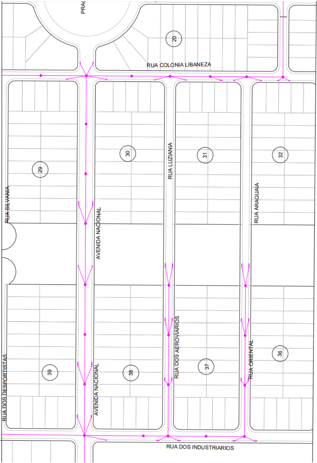
Figura 25 - Reconstrução da microdrenagem do bairro Polo Centro
