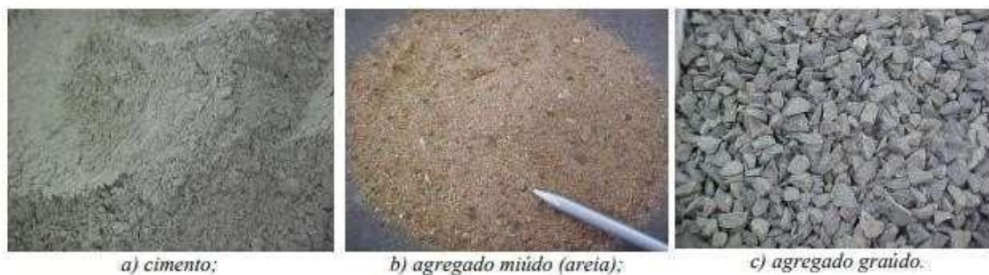
Figura 1 - Materiais básicos constituintes do concreto
