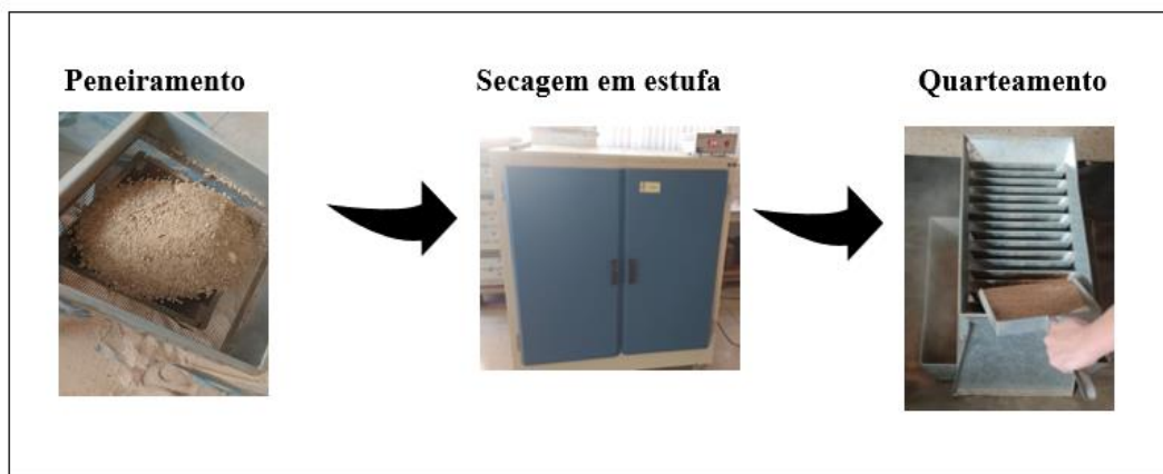
Figura 03 – Metodologia de preparação do agregado miúdo.
