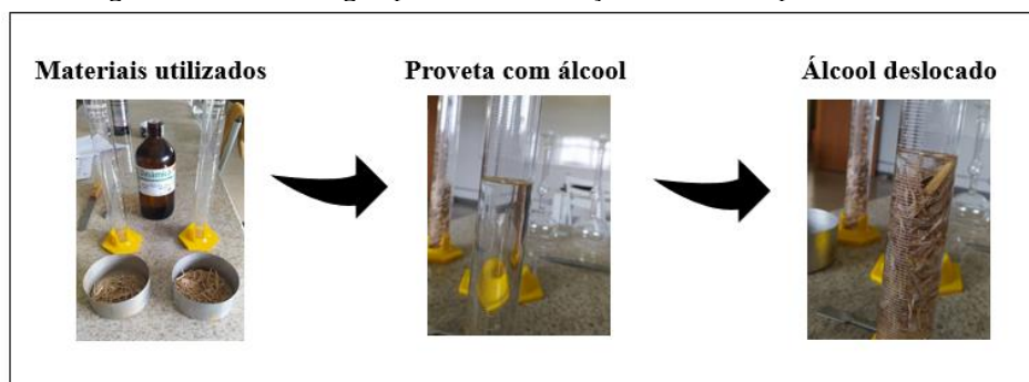
Figura 04 – Metodologia para a determinação da massa específica da FBC.
