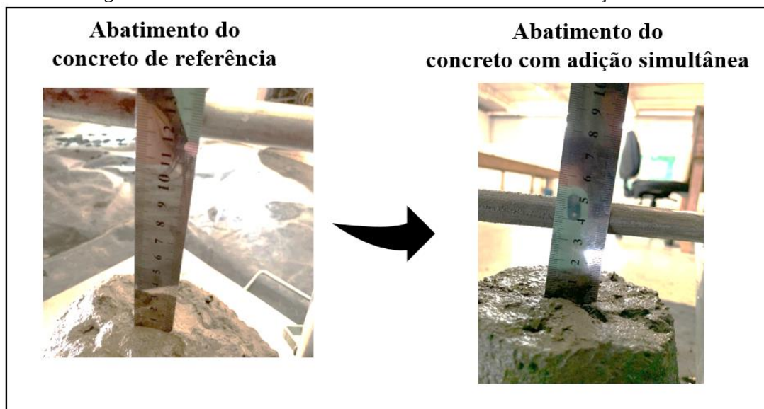
Figura 12 – Resultados de abatimento em cm do concreto com o traço adotado.
