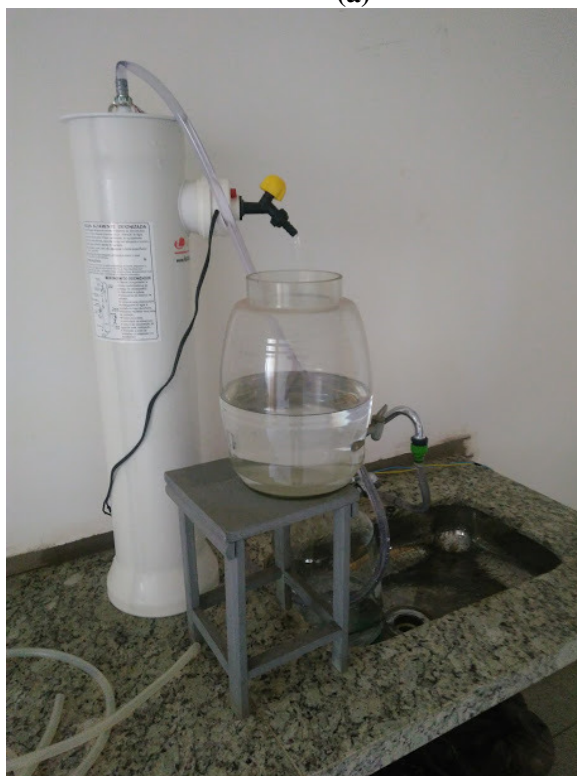
Figura 27 – Fervura das placas cerâmicas (a) coleta de água deionizada (b) placas prontas para aquecimento (c) aquecimento
