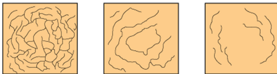
Figura 8 – Gretamento de placas cerâmicas
