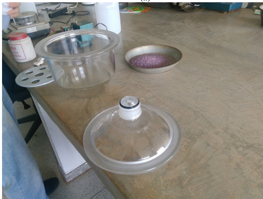
Figura 26 – Resfriamento das placas cerâmicas (a) preparação do dessecador com vaselina (b) resfriamento das placas cerâmicas
