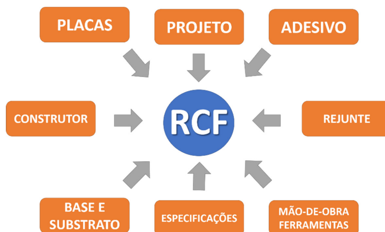
Figura 11 – Aspectos relacionados ao revestimento cerâmico de fachada
