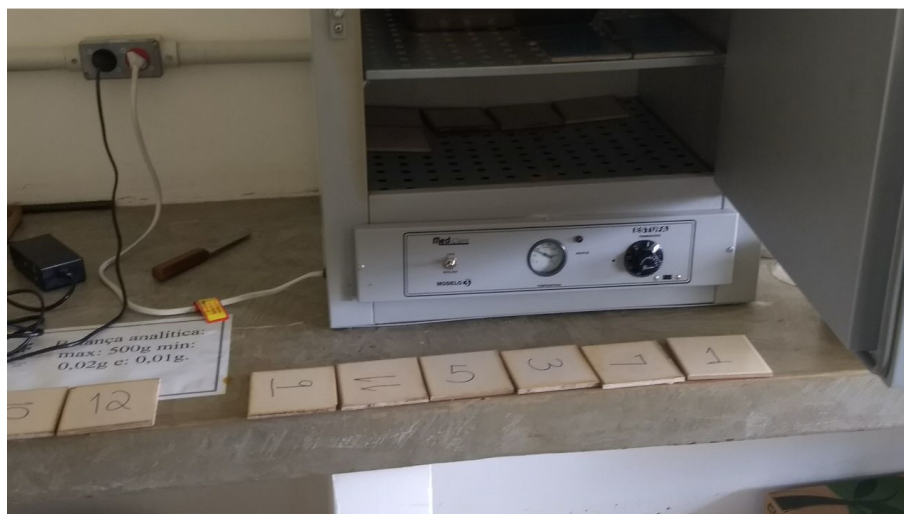
Figura 24 – Secagem em estufa a 110°C
