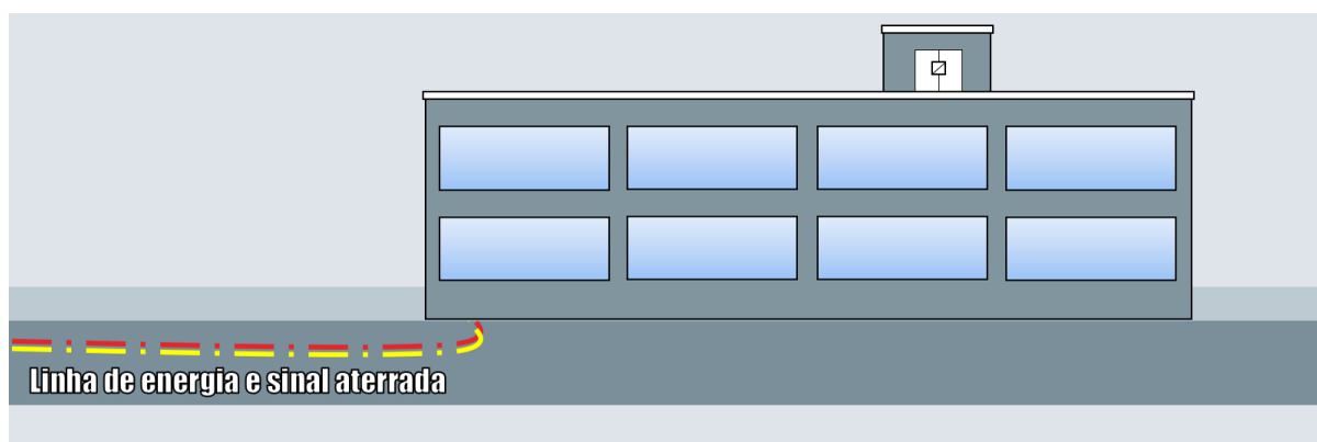
Figura 27: Linha de entrada para o prédio.
