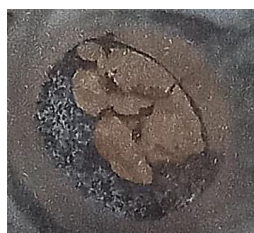
Figura 11: Estrutura sólida formada quando utilizado 0,75g de KOH como catalisador
