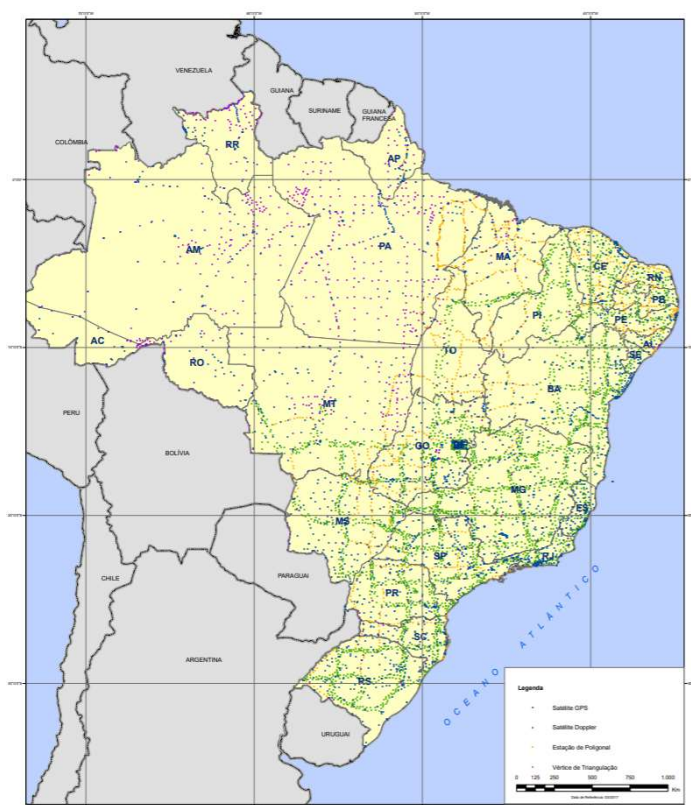
Figura 1 - Rede Planialtimétrica do Sistema Geodésico Brasileiro
