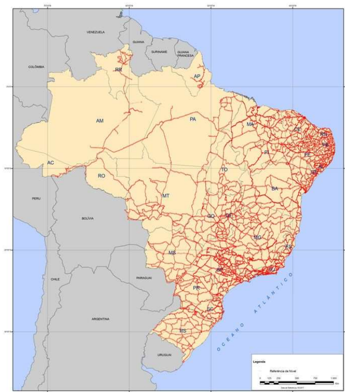
Figura 2 - Rede Altimétrica do Sistema Geodésico Brasileiro
