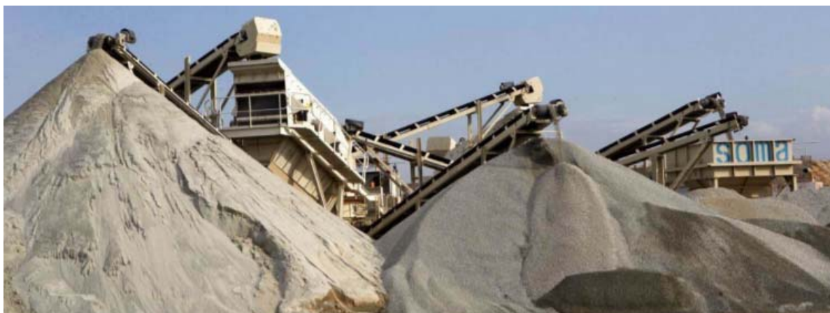
Figura 2.3 - Agregados artificiais – Produção de areia de brita
