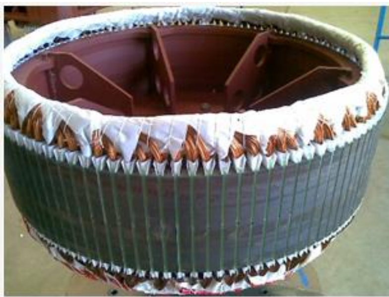
Figura 2.2 – Estator de um gerador síncrono (NIEDERLE, 2018).
