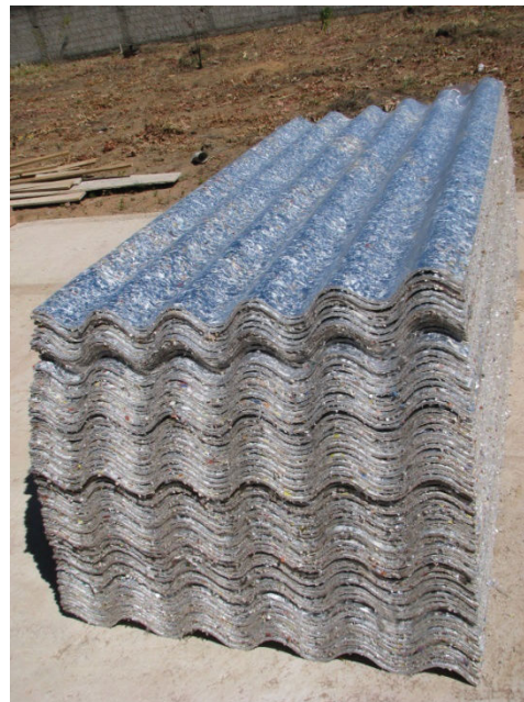
Figura 6: Telhas feitas de caixa de leite (Tetra Pak)
