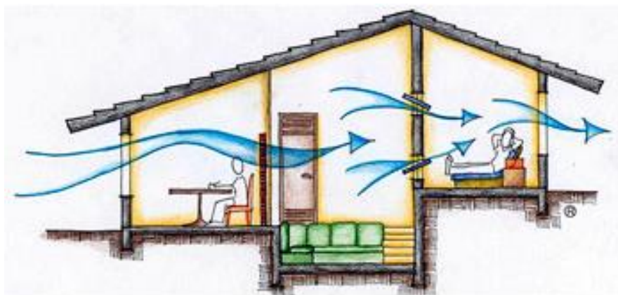
Figura 10 - Uso da ventilação cruzada para potencializar a ventilação
