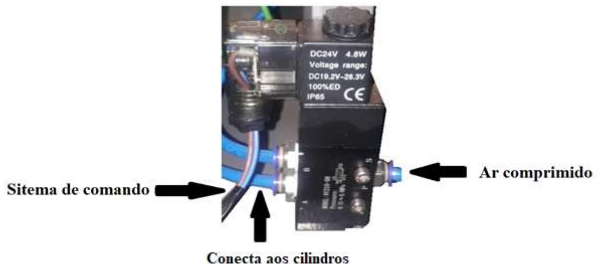
Figura 16 - Válvula solenoide 5/2 vias 1/4 modelo: 4V210-08
