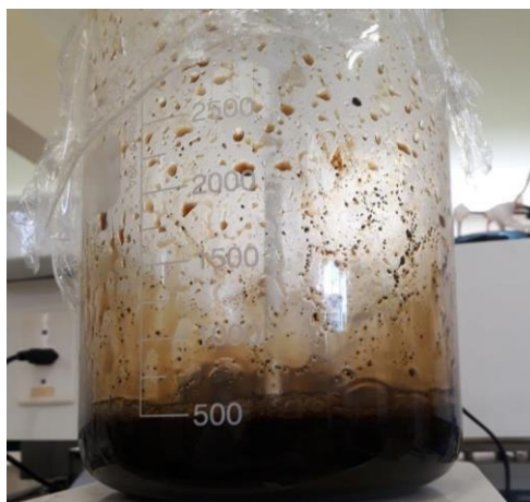
Figura 8: Fotografia da mistura obtida após a reação de coprecipitação de íons Fe II e Fe III na presença de carvão ativado.
