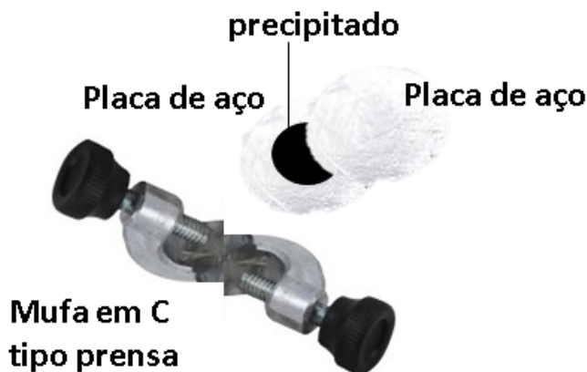
Figura 3 - Montagem de um sistema para aplicação de pressão no precipitado
