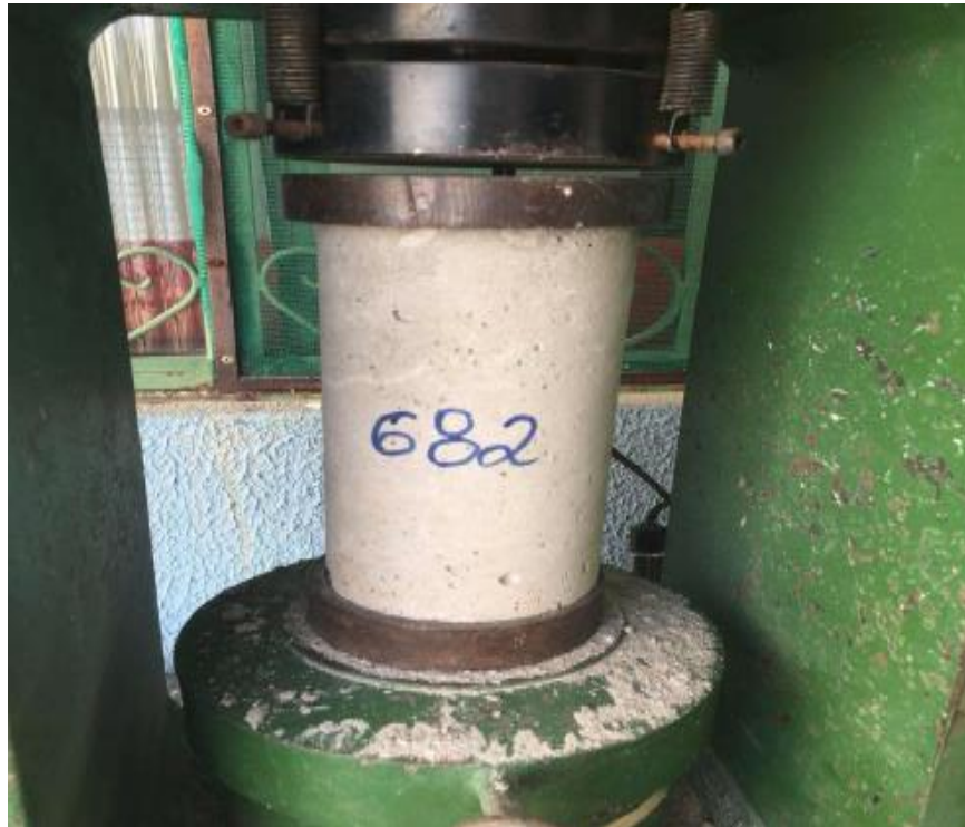
Figura 2.8.8.2.1 – Corpo de prova antes do rompimento
