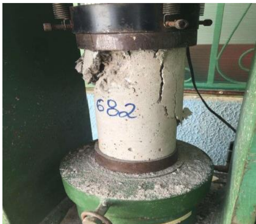
Figura 2.8.8.2.2 – Corpo de prova após o rompimento
