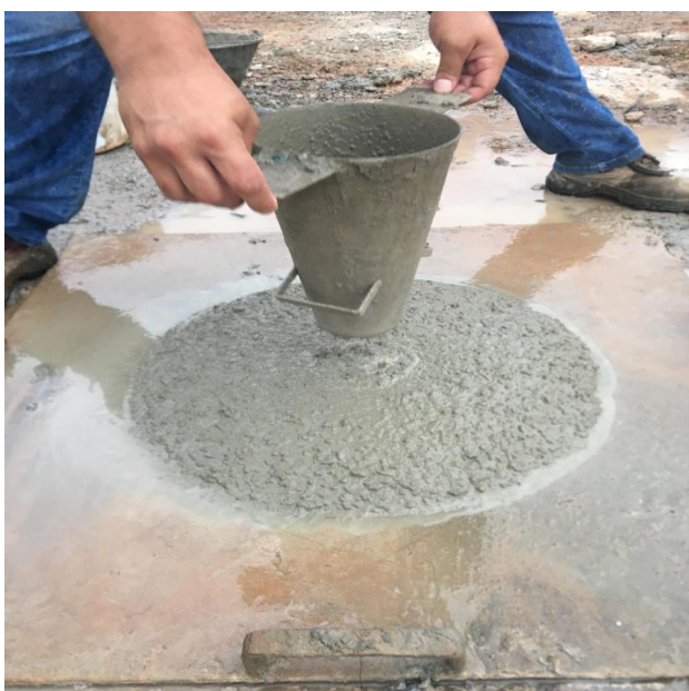
Figura 2.8.8.1.2 – Teste de Slump Flow
