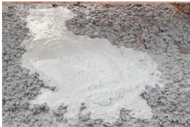
Figura 2.9.6 – Exsudação do concreto
