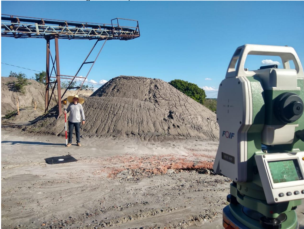
Figura 7 - Estação total FOIF Modelo RTS 105
