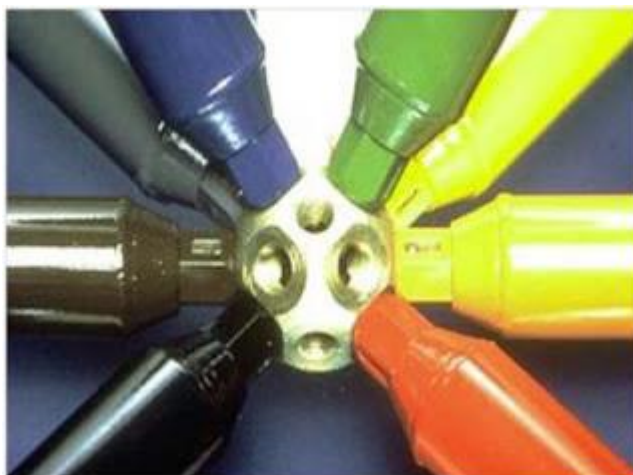
Figura 7: Nó mero é conhecido por todo mundo, por ser muito útil para estruturas espaciais, cada nó pode ligar até 18 barras, elas ficam rosqueadas na esfera
