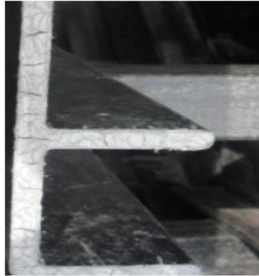
Figura 23 – Perfil E que apresentou fissurações internas.
