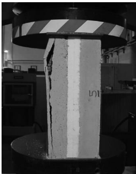
Figura 38 - Falha típica do painel
