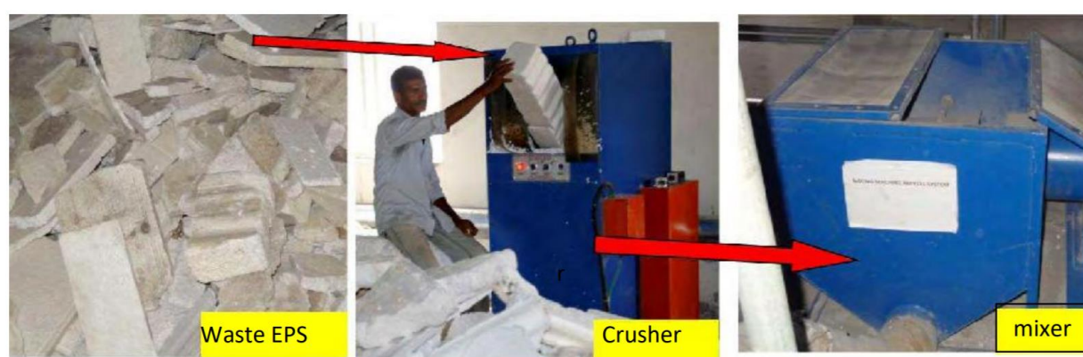
Figura 40 - Processo mecânico de reciclagem do EPS residual
