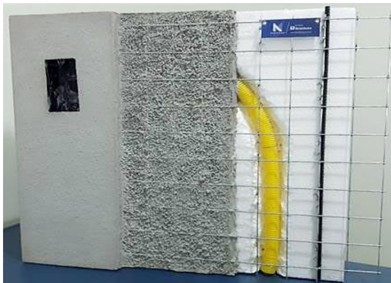
Figura 23 - Montagem dos sistemas na parede de EPS
