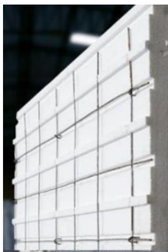
Figura 10 - Cavidades no painel EPS revestido com malha de aço
