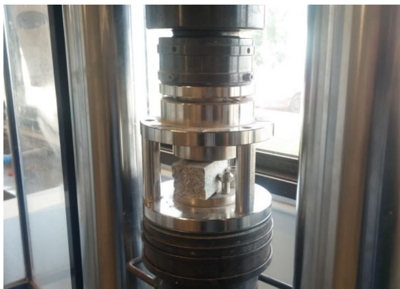
Figura 14 – Ensaio de resistência à compressão
