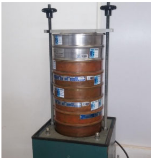
Figura 6 – Agitador mecânico de peneiras
