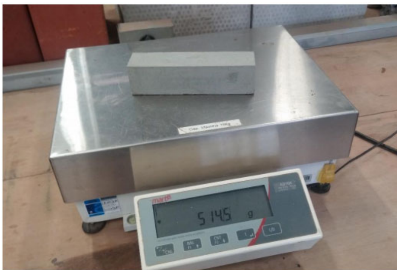
Figura 11 – Ensaio de densidade de massa no estado endurecido
