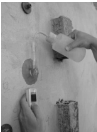
Figura 38 – Realização do ensaio de permeabilidade/absorção de água
