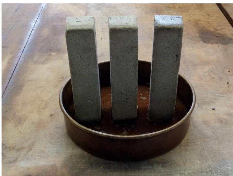
Figura 12 – Ensaio de absorção de água por capilaridade
