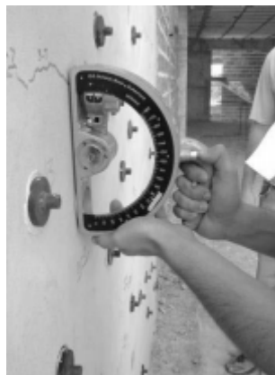
Figura 39 – Realização do ensaio de esclerometria de pêndulo
