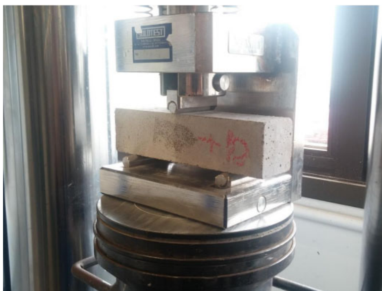
Figura 13 – Ensaio de resistência à tração na flexão
