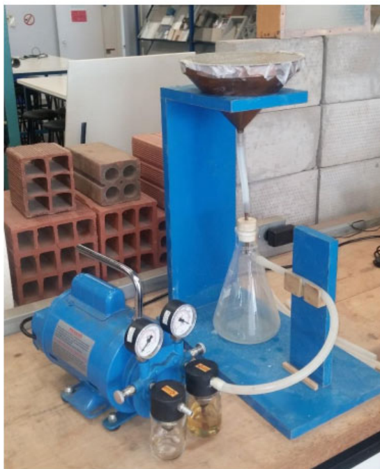
Figura 9 – Ensaio de retenção de água
