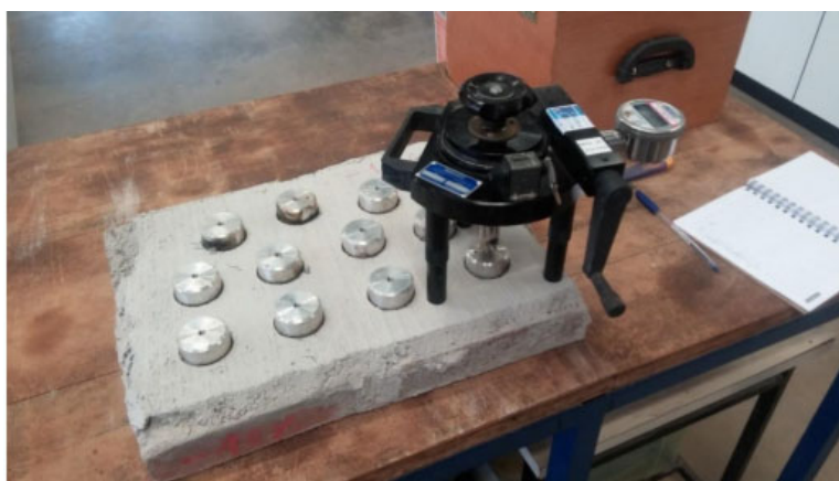
Figura 17 – Execução do arrancamento
