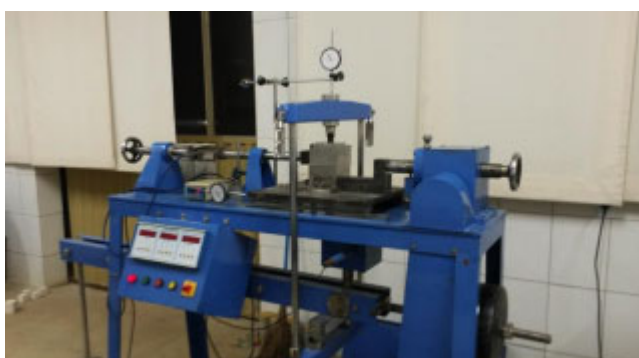
Figura 32 – Máquina utilizada no ensaio de cisalhamento direto
