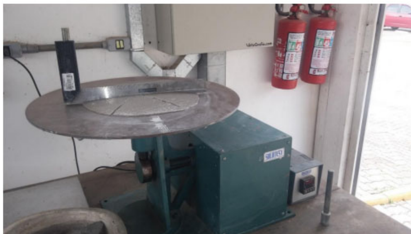
Figura 8 – Determinação do índice de consistência
