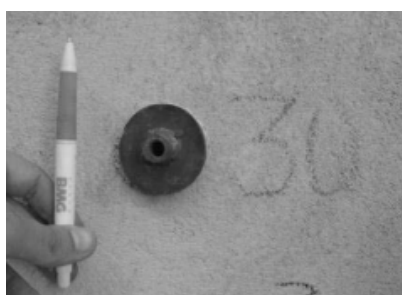
Figura 35 – Pastilha fixada no revestimento
