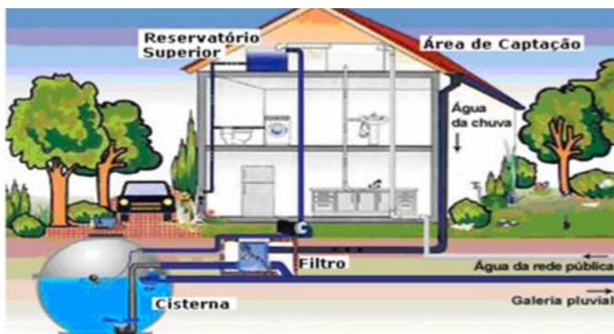
Figura 18 - Esquema de funcionamento de sistema de aproveitamento de água de chuva
