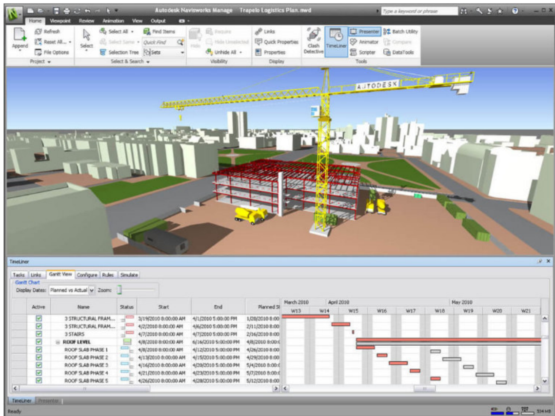
Figura 5 – Simulação 4D gerada pelo software Navisworks da Autodesk
