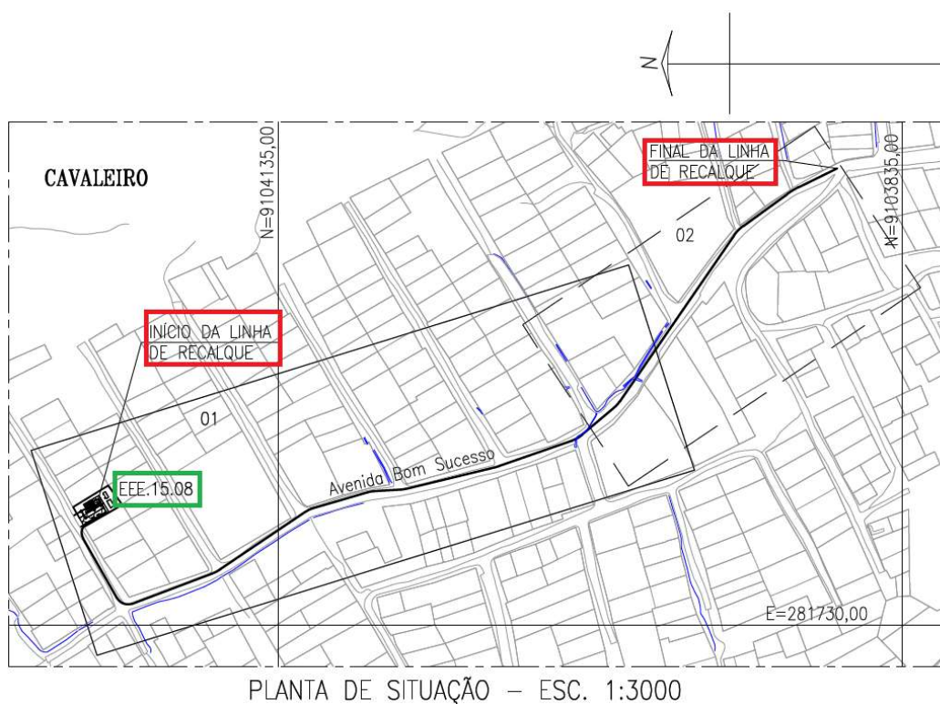
Figura 23 - Planta de situação da linha de recalque 15.08.
