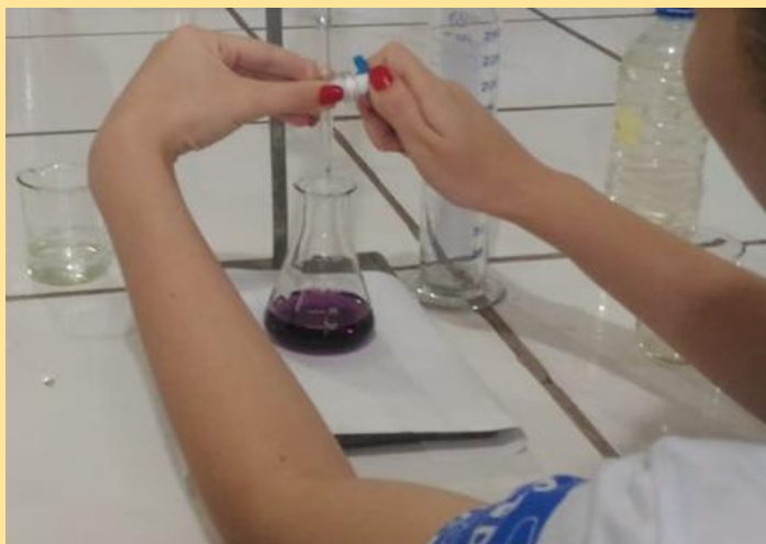
Figura 09 - Ponto de viragem / determinação da dureza
