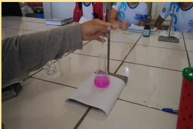
Figura 04 - Ponto de viragem/reação de neutralização ácido/base
