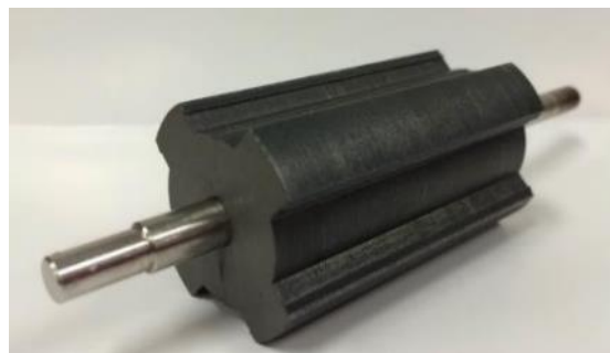
Figura 2.5 – Rotor de uma MRV real com quatro polos [17]
