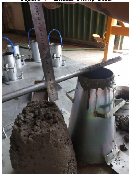
Figura 4 – Ensaio Slump Test .
