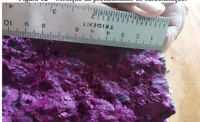
Figura 12 – Medição da profundidade de carbonatação.
