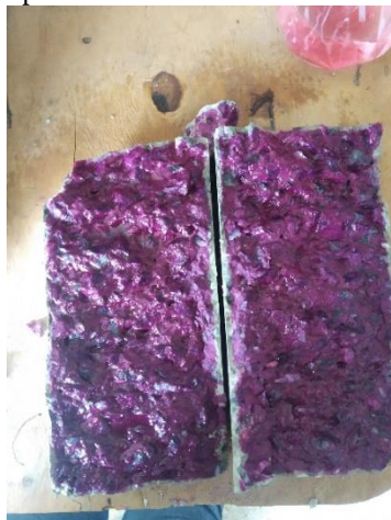
Figura 10 – Corpo de prova com a frente de carbonatação pouco avançada.
