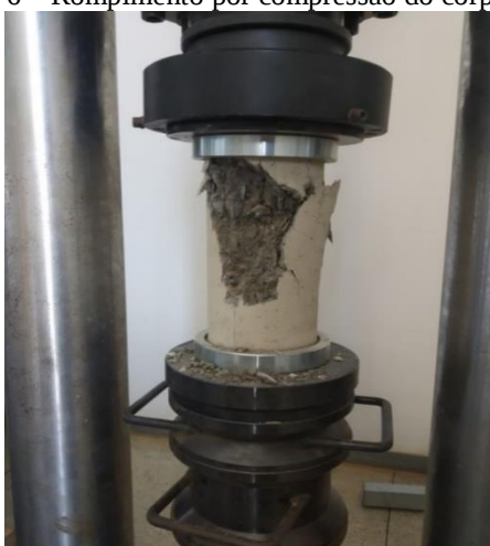
Figura 6 – Rompimento por compressão do corpo de prova.
