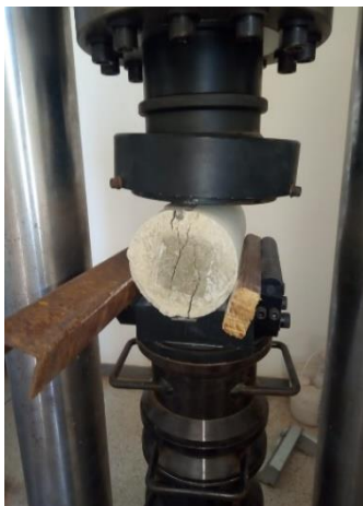
Figura 7 – Rompimento por ensaio a tração por compressão diametral.
