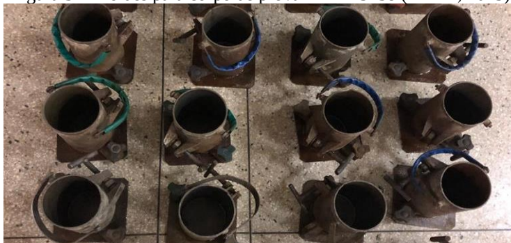
Figura 3 – Moldes para corpo de prova - NBR 5738 (ABNT, 2015)
