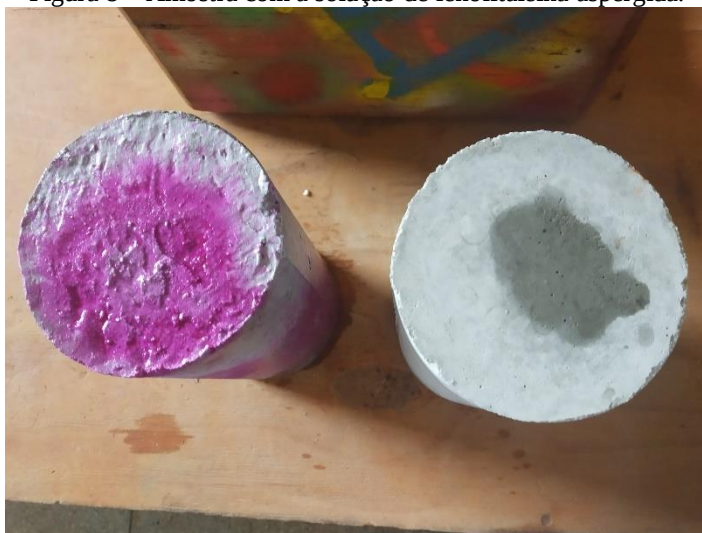
Figura 8 – Amostra com a solução de fenolftaleína aspergida.
