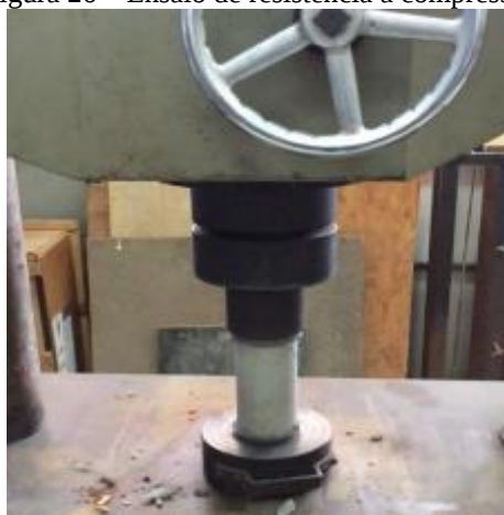
Figura 26 – Ensaio de resistência a compressão
