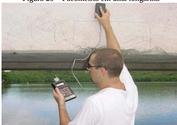
Figura 29 – Pacometria em uma longarina
