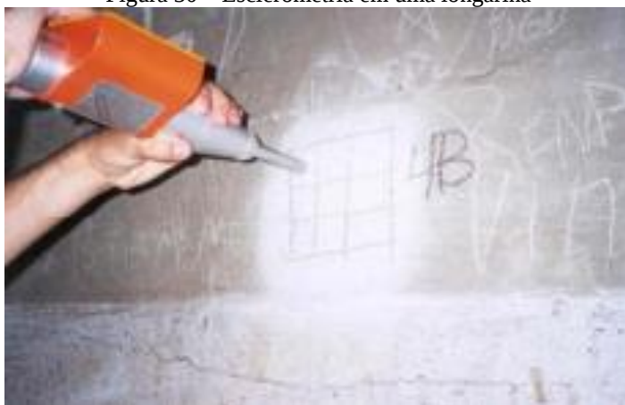
Figura 30 – Esclerometria em uma longarina
