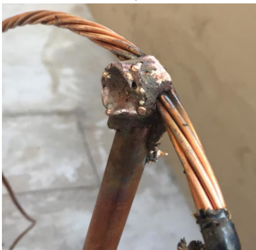
Figura 48: Visão frontal da primeira solda exotérmica
