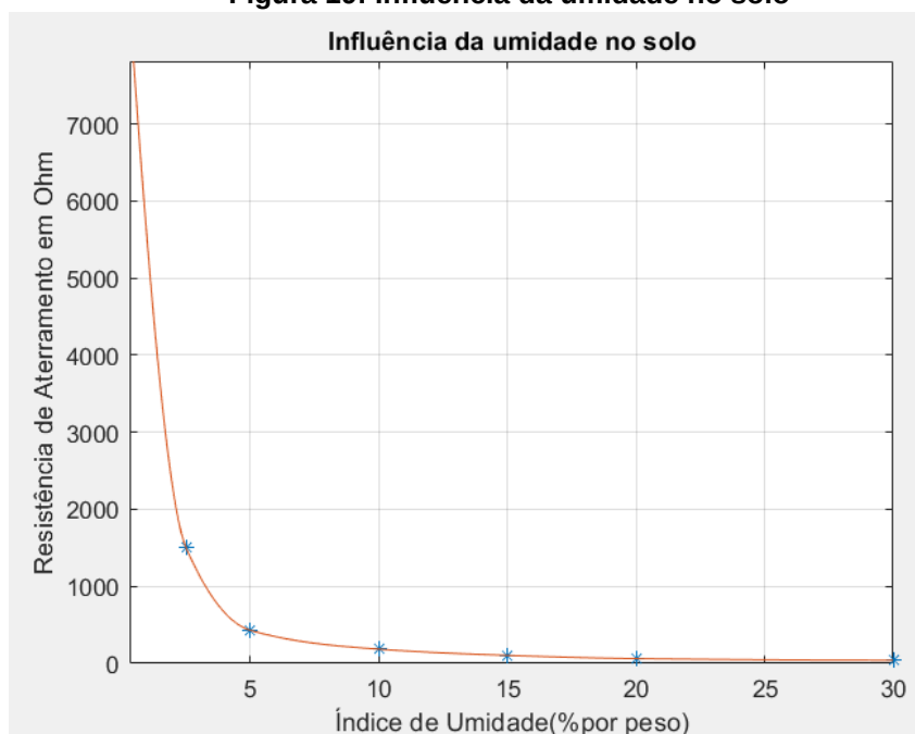
Figura 19: Influência da umidade no solo
