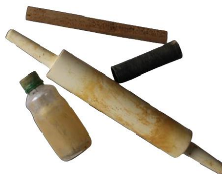
Rolo de massa, garrafas de vidro, e pedaços de cano PVC para abrir a cerâmica.
