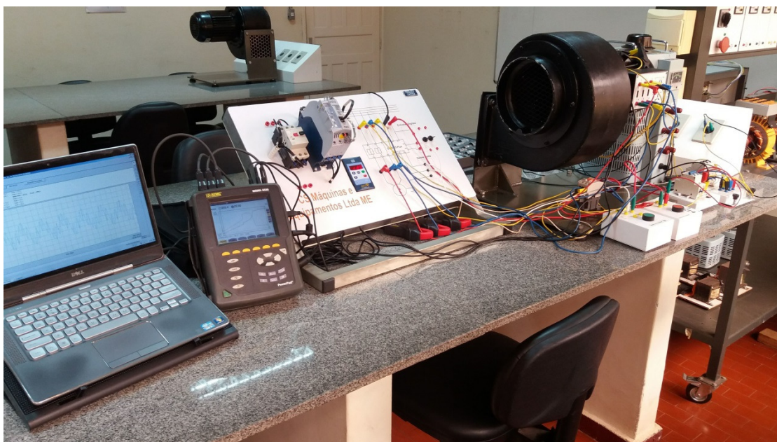
Figura 5. 9 – Montagem para registro das curvas de tensão e corrente no momento de partida do MIT utilizando uma soft-starter
