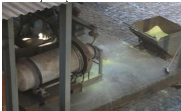
Figura 3 - Fornalha utilizada para a queima do enxofre utilizado na clarificação do caldo.
