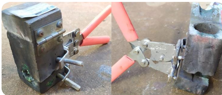
Figura 81 - Molde Cadin utilizado para realização de soldas
