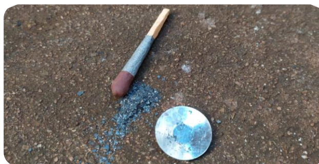
Figura 82 - Pó exotérmico, disco metálico e palito ignitor
