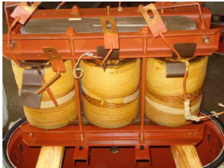
Figura 28 – Foto do transformador trifásico de 15 KVA utilizado na simulação.
