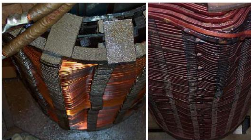
Figura 16 – Deformação livre ( free buckling ) no enrolamento de um transformador.
