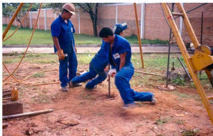
Figura 1.7 - Cravação do amostrador no solo padronizadas em norma
