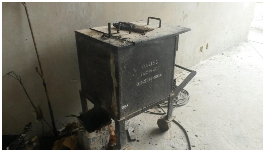
Figura 21 – Caldeira eléctrica para aquecimento do asfalto usado para manta asfáltica
