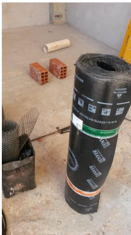
Figura 16 – Manta asfáltica utilizada
