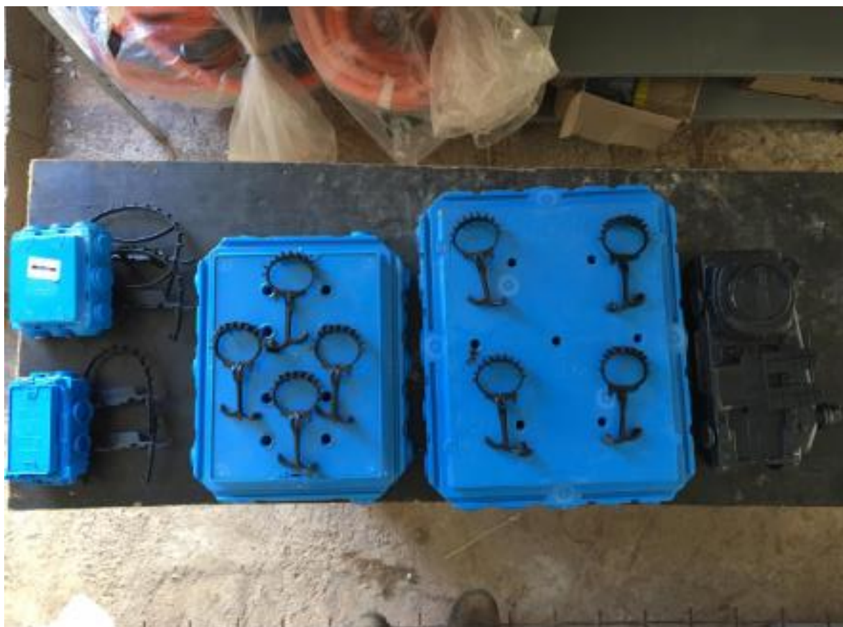
Figura 11: Caixas de passagem e quadros com seus respectivos espaçadores
