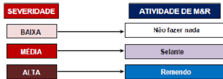
Figura 3.5 Árvore de decisões para trincas longitudinais
