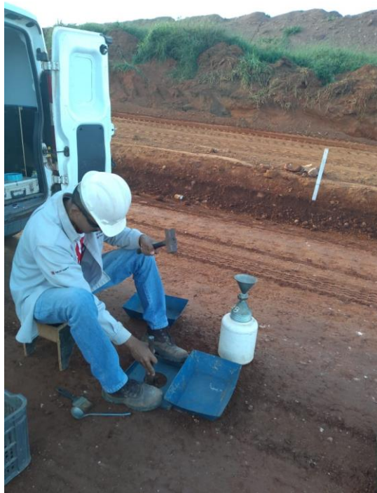
Figura 9 - Conferência do grau de compactação da camada
