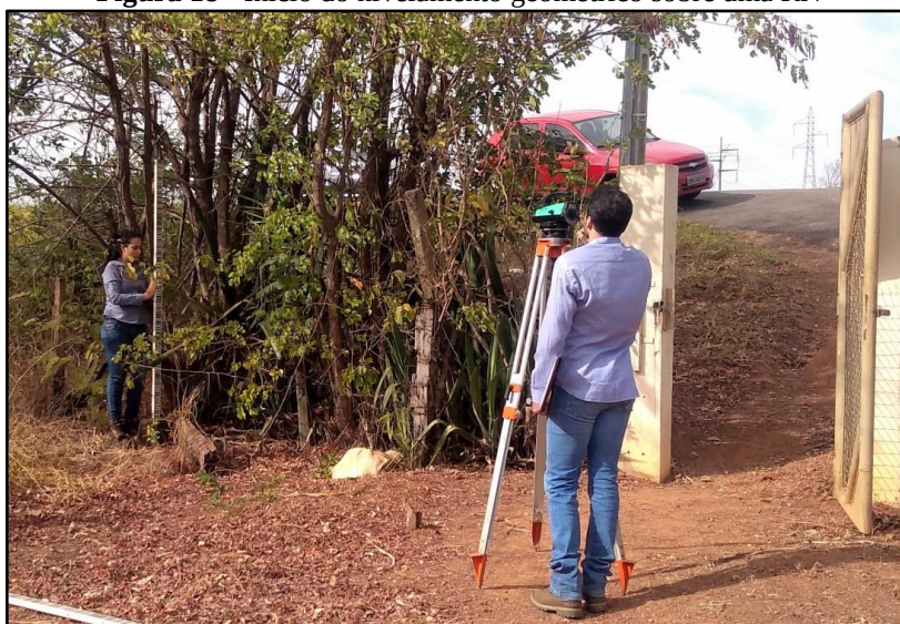
Figura 18 - Início do nivelamento geométrico sobre uma RN
